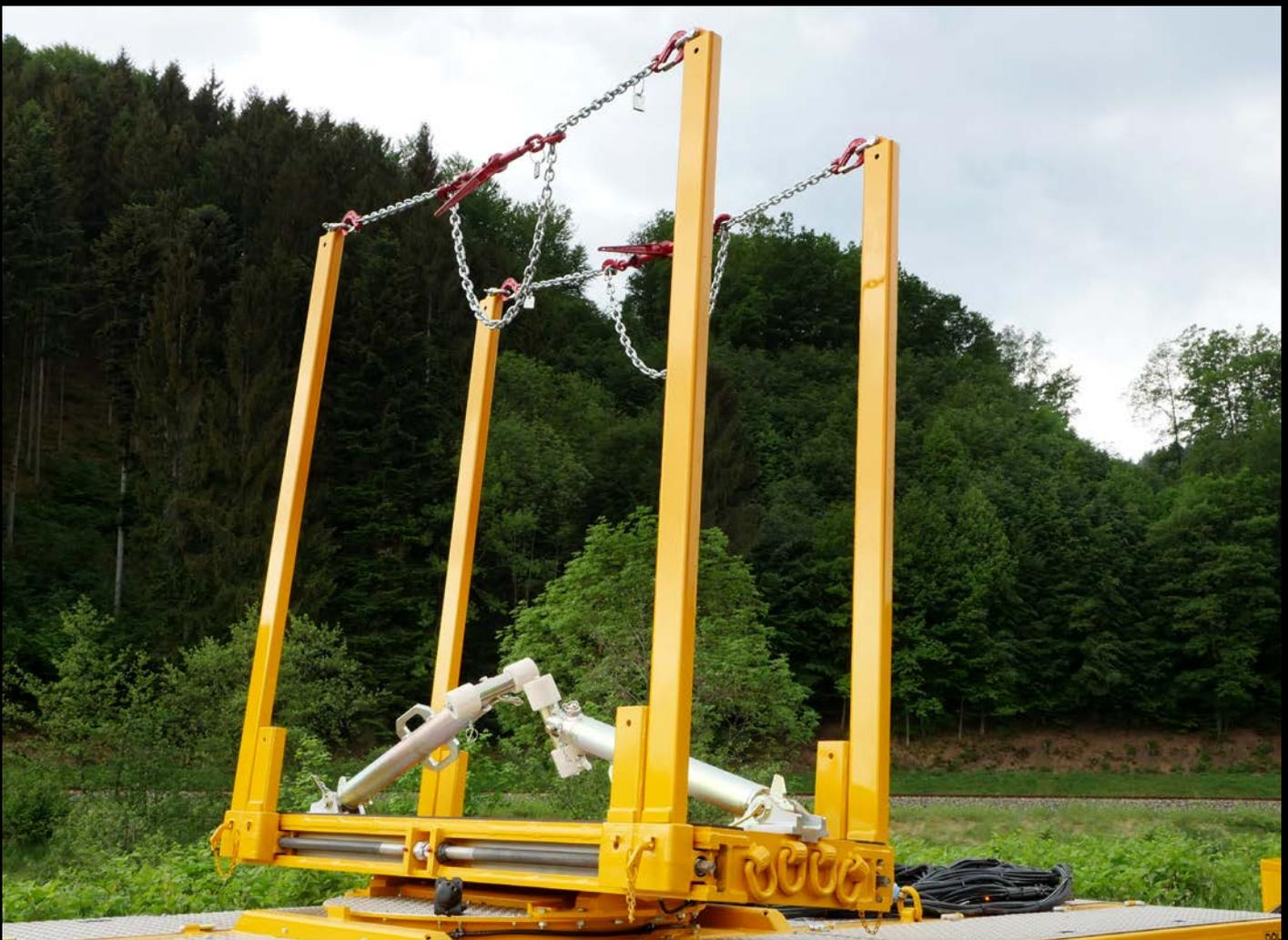
Rungen in verschiedenen Längen, Spannketten zwischen den Rungen, Schrägsprößen steckbar
