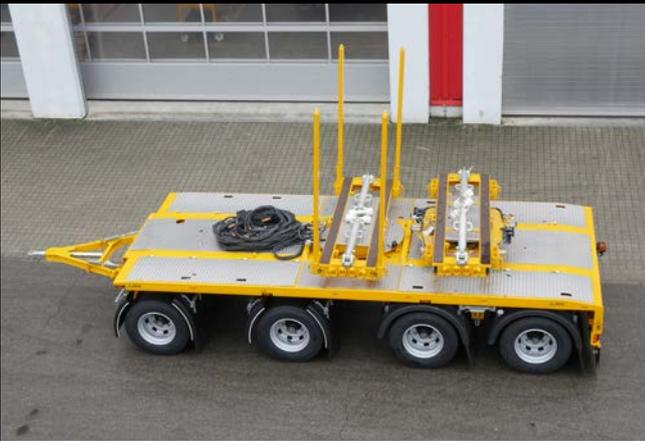
4-Achs-Nachläufer mit VARIO Fahrwerk
