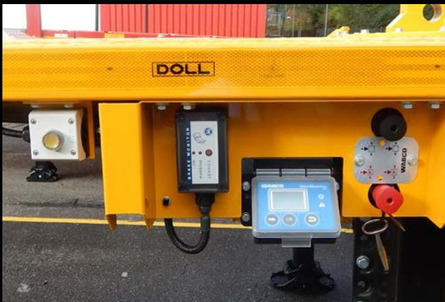
Elektronische Luftfederung mit SMART BOARD
