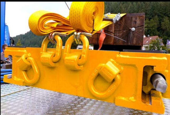
Zurrringe am Schemel montiert
