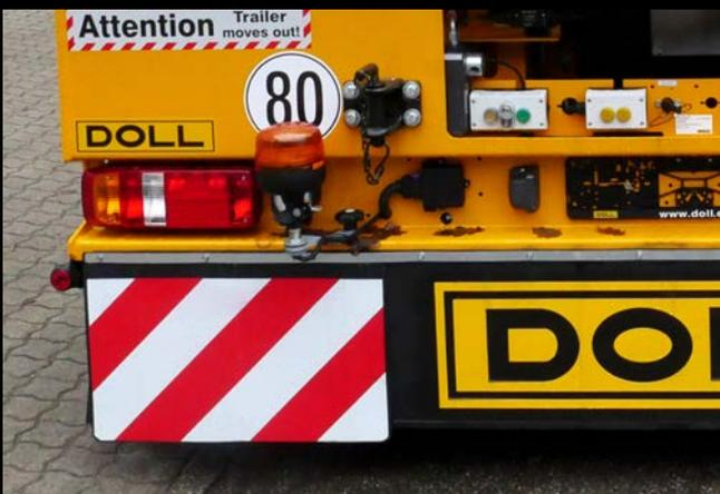
Warntafel, LED-Rundumleuchte (steckbar), Rangierkupplung
