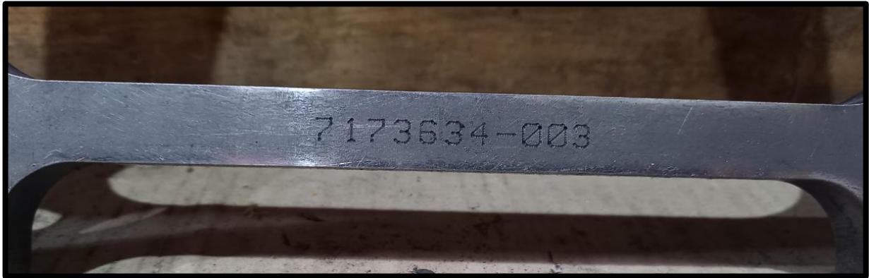
Abbildung 7 – Beschriftung mit DOLL-Artikelnummer auf Stahlbauteil
