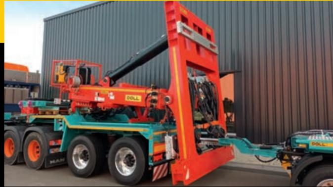
Hubadapter mit hydraulischer Lifteinrichtung für 3-, 4- oder 5-Achs-Lkw (abhängig von zulässiger Achslast)
