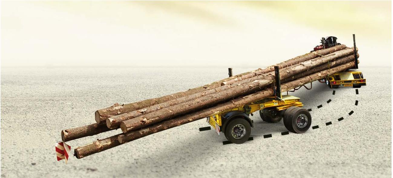
Dieses Lenksystem basiert auf dem Wirkprinzip der ratio Lenkung. Allerdings wird erstmals der Selbstlenker nicht dem Lkw „nachgezogen“, sondern durch eine **elektronische Steuerung aktiv und intelligent gesteuert**. Zusätzlich sind verschiedene Funktionen verfügbar, die das Fahrzeug noch **sicherer, komfortabler und direkter steuerbar** machen.
